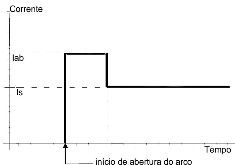
Figura 7.2 – Forma de onda da corrente no “Hot Start”
